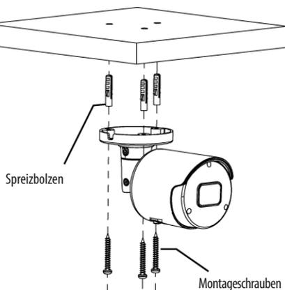
Setzen Sie drei Spreizdübel in die Decke ein und befestigen Sie das Gerät mit drei Montageschrauben.
