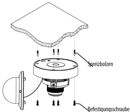
Verwenden Sie die auf dem Positionsaufkleber angegebene Position, um die für die Montage der Kamerabasis erforderlichen Löcher zu bohren. Führen Sie die Spreizschraube in die Löcher ein. Passen Sie die Montageöffnungen des Sockels an die Position der Spreizschrauben an, und setzen Sie dann die Befestigungsschrauben durch die Montageöffnung des Sockels in die Spreizschraube ein. Ziehen Sie die Befestigungsschrauben an, um sicherzustellen, dass die Kamerabasis sicher befestigt ist.
