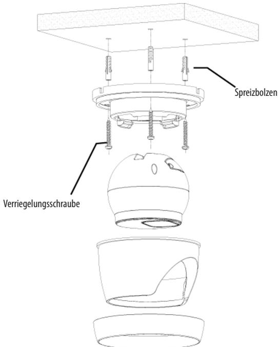
Befestigen Sie den Sockel, indem Sie um den Aufkleber herum Sicherungslöcher bohren, drei Spreizbolzen in die Löcher stecken und mit drei Sicherungsschrauben befestigen.
